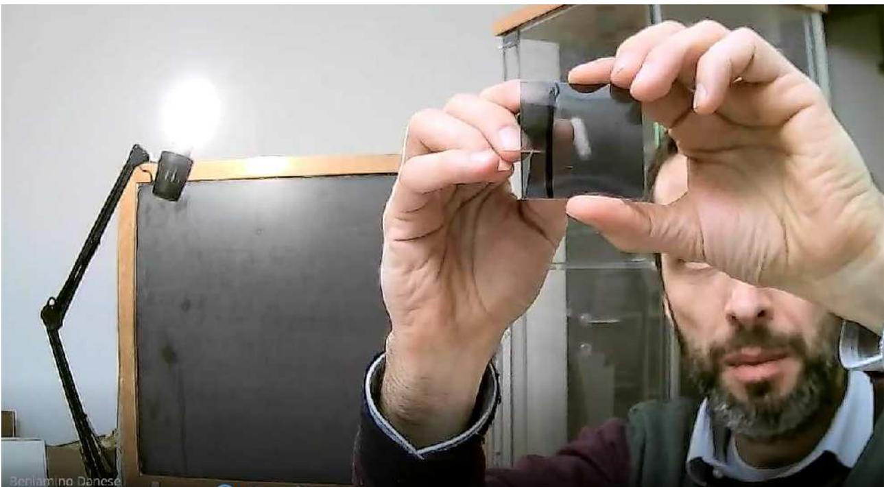
L'esperimento di Malus (la luce del riflesso è polarizzata e ruotando il polarizzatore possiamo sopprimerla) ci permette di "caratterizzare" il polarizzatore.
